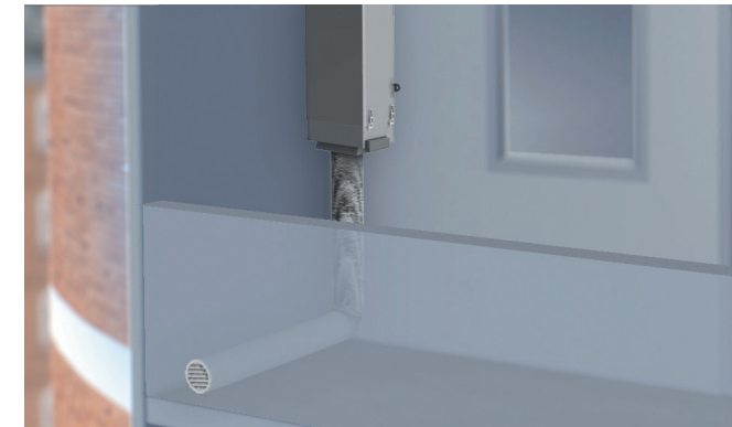
На балконе с предустановленным адаптером удалённого за- бора воздуха.
