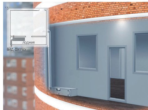
Монтаж на лоджии. Способ 2.
